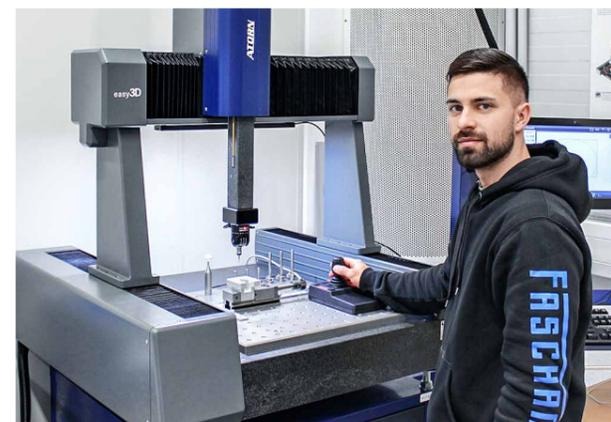
Für Dominik Piereder, Messmaschinenbediener bei Faschang, eignet sich das Atorn-3D-Koordinatenmessgerät easy3D ideal zur Vermessung von Regelgeometrien in der Fertigung.
